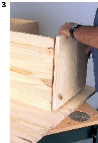
3. Encoller et poser les lamellos sur chaque montant extérieur, et les assembler avec le plateau et le montant en croix.
