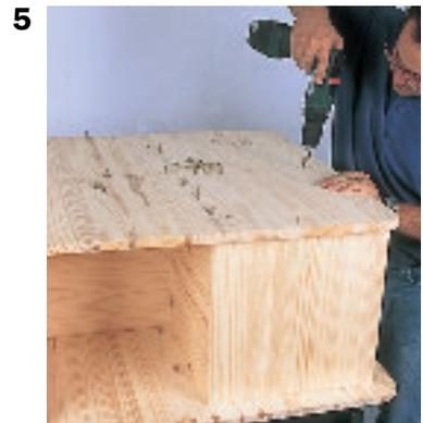
5. Visser le plateau inférieur sur les montants avec des vis "aggl" de 60 mm de longueur.
